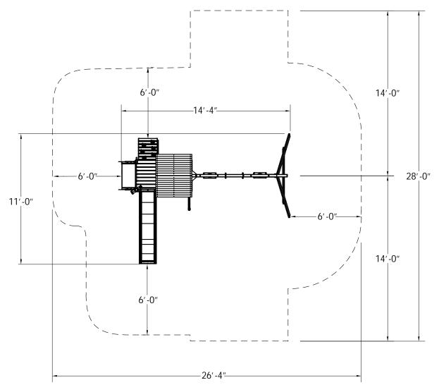
MINIMUM USE ZONE FOR PLAY EQUIPMENT SHALL EXTEND NO LESS THAN 72" FROM ALL SIDES OF THE PLAY STRUCTURE. SWING USE ZONE EXTENDS NO LESS THAN 168". SWINGS MUST HAVE A MINIMUM CLEARANCE OF 8" ABOVE THE PROTECTIVE SURFACING.
